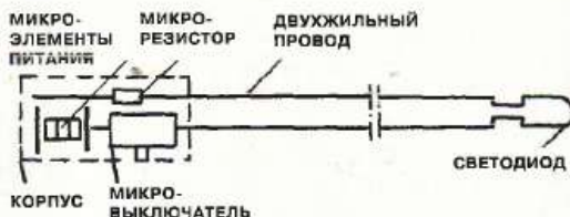
Схема книжного фонарика (патент 1995 года).
